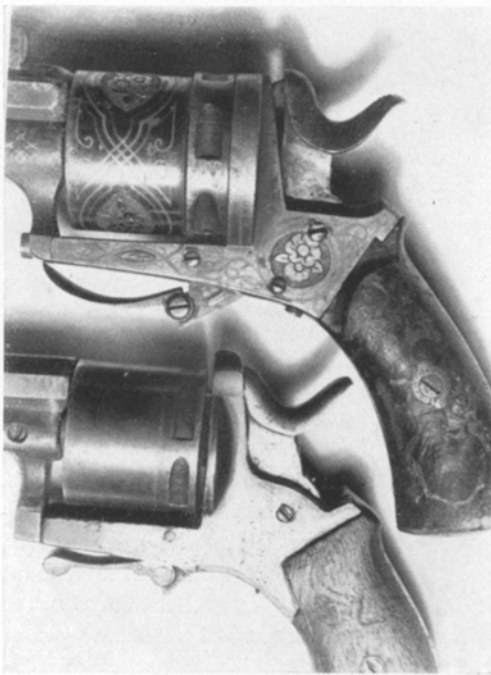
Abb. 2. Oben: Exakt gearbeitete Waffe. Unten: Waffe mit schlecht abgeschlossenen Bohrungen (Tatwaffe).
